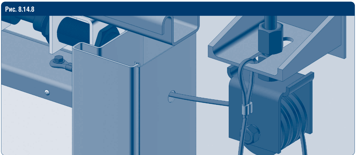
Рис. 8.14.8 Зафиксируйте трос на кронштейне крепления к стене с помощью обжимной втулки.
